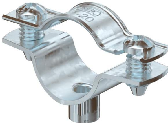
Abrazadera para el montaje de tubos y cables en la pared, el techo y el suelo. Con tapa autoblocante. Fijación a través de inserción con rosca interior. Superficies G y T a partir de tamaño de abrazadera 20 apropiado para el montaje con pistolas clavadoras y pistolas de pernos.
