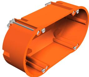
Caja portamecanismos doble, para 2 mecanismos o 1 mecanismo doble, con 4 tornillos para mecanismos. Dimensiones según DIN 49073-1, para un grosor de placa de entre 7 y 35 mm. Distancia estándar de combinación de 71 mm, 14 aberturas rompibles para conductores NYM, líneas de datos y tubos de 20 mm de Ø, grado de protección IP30. Norma IEC 60670-1, IEC 60670-22 y DIN 49073-1.
