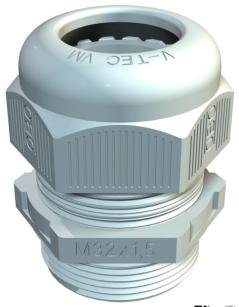
Prensaestopas con rosca de conexión métrica de tipo con tuerca de capuchón, para cajas de derivación, carcasa, cajas de distribución en sector privado e industrial. Con descarga de tracción y labio de sellado integrado , probado según DIN EN 62444. Clase de protección IP68. Se puede utilizar entre -20 °C y
