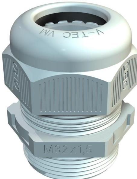
Prensaestopas con rosca de conexión métrica de tipo con tuerca de capuchón, para cajas de derivación, carcasa, cajas de distribución en sector privado e industrial. Con descarga de tracción y labio de sellado integrado, probado según DIN EN 62444. Clase de protección IP68. Se puede utilizar entre -20 °C y +65 °C.
