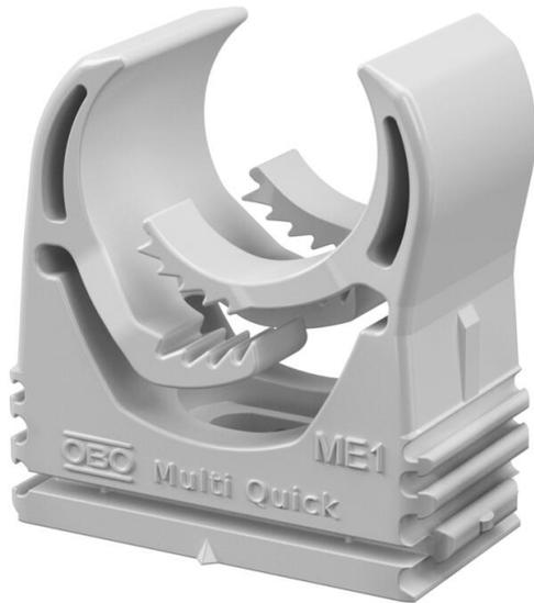
Abrazadera de superficie para el alojamiento de tubos métricos y tubos para instalación eléctrica Quick-Pipe. Rango de sujeción flexible de varios milímetros. Posibilidades de fijación universales en pared y techo en zonas interiores y exteriores. Montaje de tubo sin herramientas. Se puede colocar en línea también con abrazadera Quick o starQuick de OBO.
