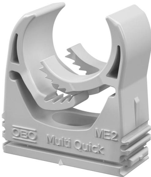
Abrazadera de superficie para el alojamiento de tubos métricos y tubos para instalación eléctrica Quick-Pipe. Rango de sujeción flexible de varios milímetros. Posibilidades de fijación universales en pared y techo en zonas interiores y exteriores. Montaje de tubo sin herramientas. Se puede colocar en línea también con abrazadera Quick o starQuick de OBO.
