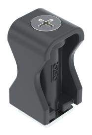
Versión para cargas pesadas, también adecuado para carriles con ancho de ranura de 16 ÷ 17 mm; cuerpo de abrazadera de poliamida, gris claro RAL 7035; piezas metálizas de acero, galvanizado en caliente.
