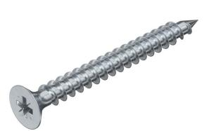
Acero endurecido, electrogalvanizado y con recubrimiento con Hostaflon (PTFE). Cabeza avellanada con ranura en cruz (destornillador tamaño 2, a excepción del Ø de 6 mm que es tamaño 3).
