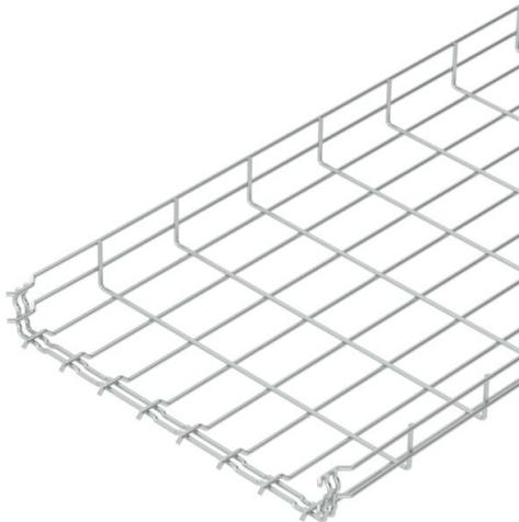
Bandeja de rejilla con conexión de unión rápida con ala de 55 mm. Para la bandeja de rejilla no se necesita ningún tipo de unión, simplemente se engancha un tramo con otro. El ancho de malla es de 50 x 100 mm (excepción GRM 55/50 = 20 x 100 mm).
