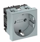
Toma de corriente con clavija de puesta a tierra simple  $0^{\circ}$ , con protección aumentada contra contacto accidental, con bornes de enchufe, de 2 polos, 16 A, 250 V~, con bornes de conexión según IEC 60884-1.
