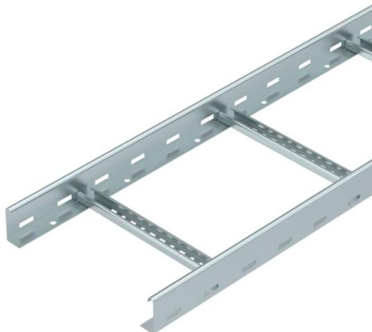
Bandeja de escalera con barra lateral perforada de ala 60 mm con peldaños de perfil en C abiertos hacia arriba (modelo VS), remachados.
