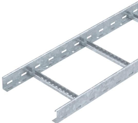
Bandeja de escalera con barra lateral perforada de ala 60 mm con peldaños de perfil en C abiertos hacia arriba (modelo VS), remachados. La bandeja de escalera se suministra plegada.
