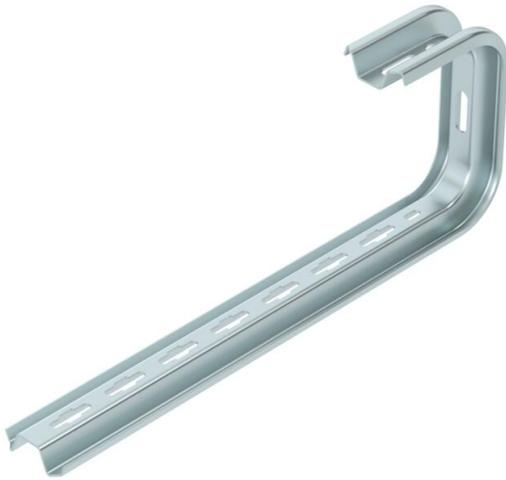
Escuadra de pared/techo TP para la fijación universal de construcciones. Importante. Si el soporte se fija directamente a la pared o al techo, por razones de estabilidad, se instala siempre una pieza distanciadora DS 4. Altura lateral máx. del sistemas de bandejas portacables de 60 mm.
