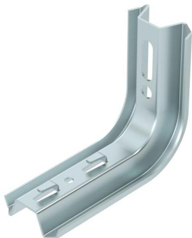
Escuadra TP con pestañas para la fijación de bandejas de rejilla sin tornillos. Si la escuadra se fija directamente al techo o se atornillan los perfiles contra el refuerzo frontal, debe instalarse una pieza distanciadora DS 4 por razones de estabilidad.
