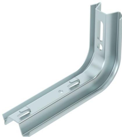
Escuadra TP con pestañas para la fijación de bandejas de rejilla sin tornillos. Si la escuadra se fija directamente al techo o se atornillan los perfiles contra el refuerzo frontal, debe instalarse una pieza distanciadora DS 4 por razones de estabilidad. Sobre la escuadra TP pueden fijarse sin tornillos las bandejas de rejilla de 50 x 100 mm p. ej. GRL, GR y GRM.
