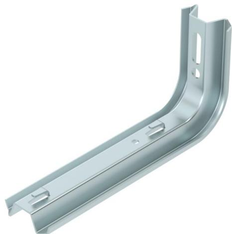
Escuadra TP con pestañas para la fijación de bandejas de rejilla sin tornillos. Si la escuadra se fija directamente al techo o se atornillan los perfiles contra el refuerzo frontal, debe instalarse una pieza distanciadora DS 4 por razones de estabilidad.
