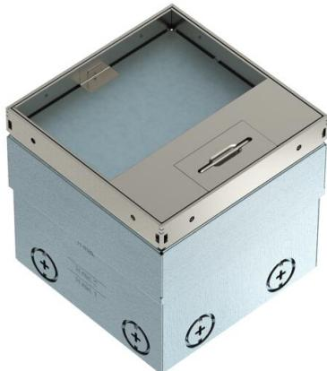
Unidad completa cuadrada para el montaje en suelos huecos y en pavimentos que precisan una limpieza en seco en zonas interiores. La carcasa empotrable dispone de entradas pretrouqueladas para tubo (M20/M25). Se puede ajustar la tapa hasta el borde superior del revestimiento del suelo mediante 4 soportes niveladores. La profundidad mínima de instalación es de 110 mm, el rango de nivelación + 25 mm.
