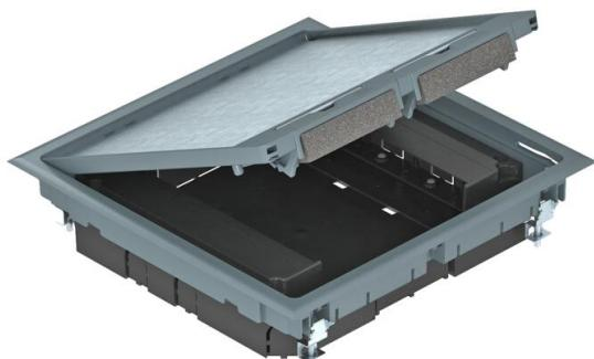
Salida de la caja GES9 con una altura de instalación fija de 55 mm para su uso en sistemas de conductos de instalación en locales secos con suelos lavados en seco en interiores. Dispone de dos cubetas para el montaje vertical de mecanismos Modul 45 y cuatro descargadores de tracción. Es necesario usar dos marcos de montaje para instalar los mecanismos Modul 45.
