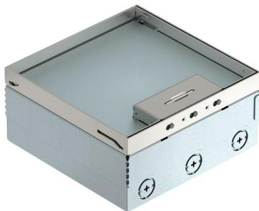
Depósito de suelo cuadrado para el uso en suelos huecos tratados en seco y suelos de mortero de interior. La carcasa empotrable dispone de entradas pre-troqueladas para tubo (M25). Con 2 soportes universales UT3 45 3. Parte superior ajustable mediante 4 soportes de nivelación en el borde superior del revestimiento de suelo. La profundidad mínima de montaje es de 95 mm y el margen de nivelación de + 30 mm.
