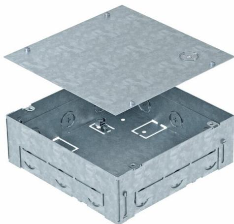
Carcasa para montaje empotrado de la unidad portamecanismos GES4-2 en suelos pavimentados. Con entradas pretroqueladas para la introducción de las canalizaciones (M25) desde los cuatro lados.
