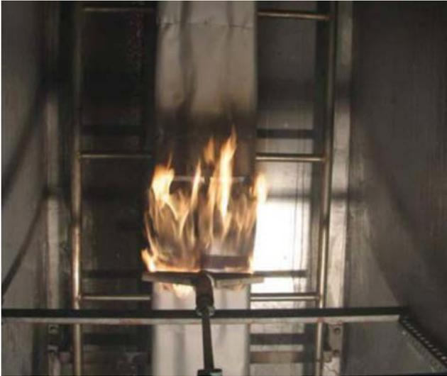
Prüfung der Kabelbandage
