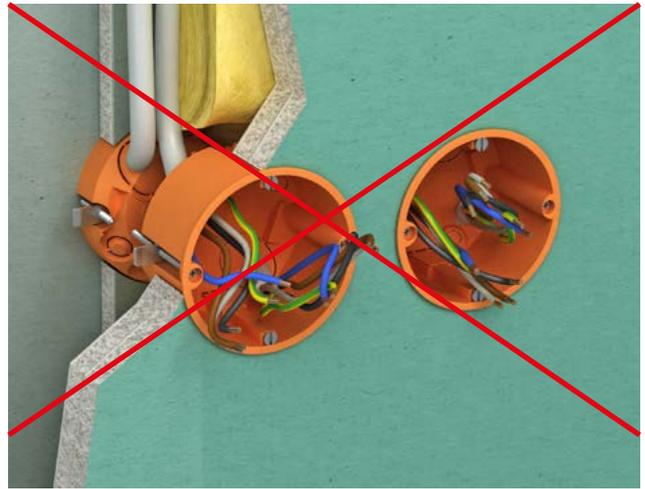
Unzulässiger Einbau von gegenüberliegenden Standard-Hohlwanddosen in leichten Trennwänden mit Feuerwiderstand.
