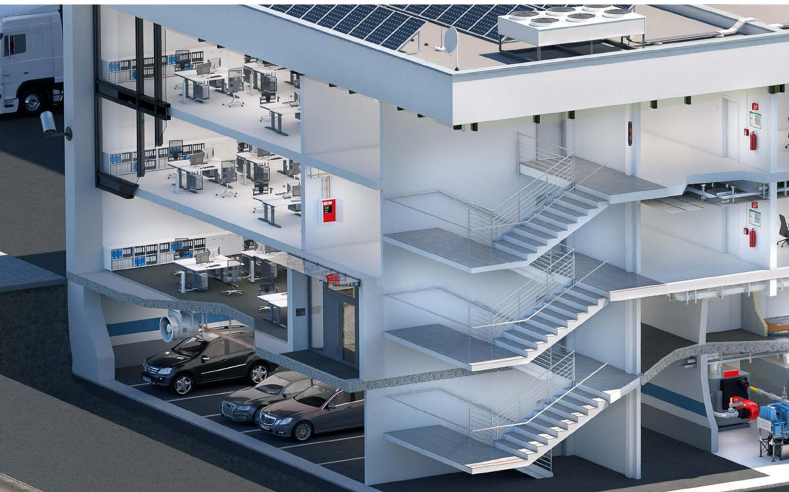
Bildung von Brandabschnitten durch Brandwände bzw. feuerwiderstandsfähige Bauteile
