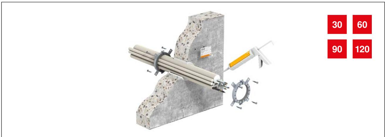
**2.4.6 Rohrmanschette PYROCOMB® Tubes**
