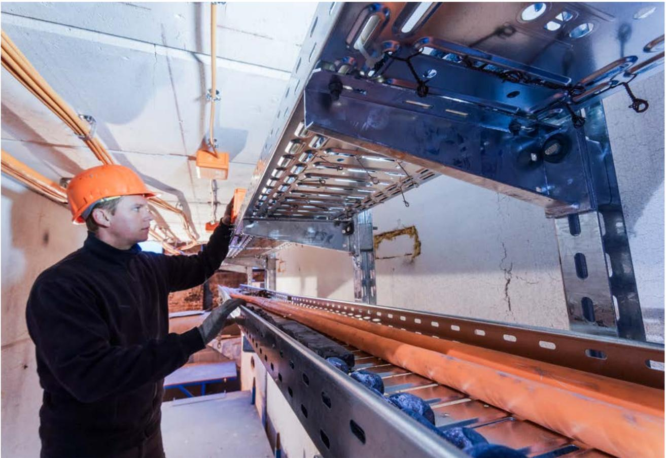
Prüfaufbau einer Funktionserhalt-Kabelanlage
