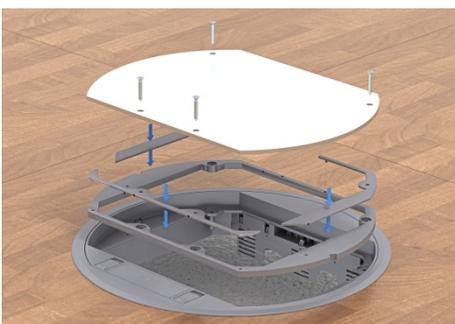
Stahlblechdeckel und Kunststoffplatte entfernen, Distanzleisten einlegen oder entfernen, Platte einlegen und Deckel wieder festschrauben.
