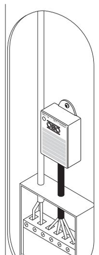
Montaje del ÜSM-20-230I1PE65 fuera de la caja de conexiones
